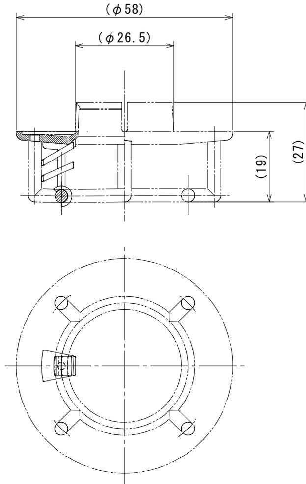
◎対向する小区面型及び水道連結型ヘッドの離間距離が3m以下となる場合は、双方のガード付きシーリングプレートに被水防止板Tを対向するスプリンクラーヘッドの方向に合わせて取り付けて下さい。
