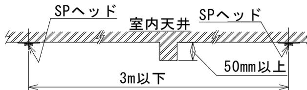
※ 但し、対向するヘッドの離間距離が3m以下でも、その間に50mm以上の突き出し状の障害物が天井にある場合（上図参照）、双方のガード付きシーリングプレートに被水防止板Tを取り付ける必要はありません。
