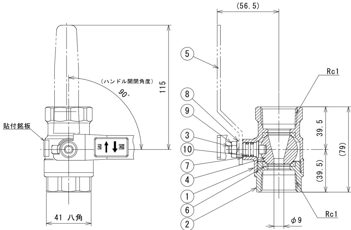
ノズル内蔵型末端試験弁
