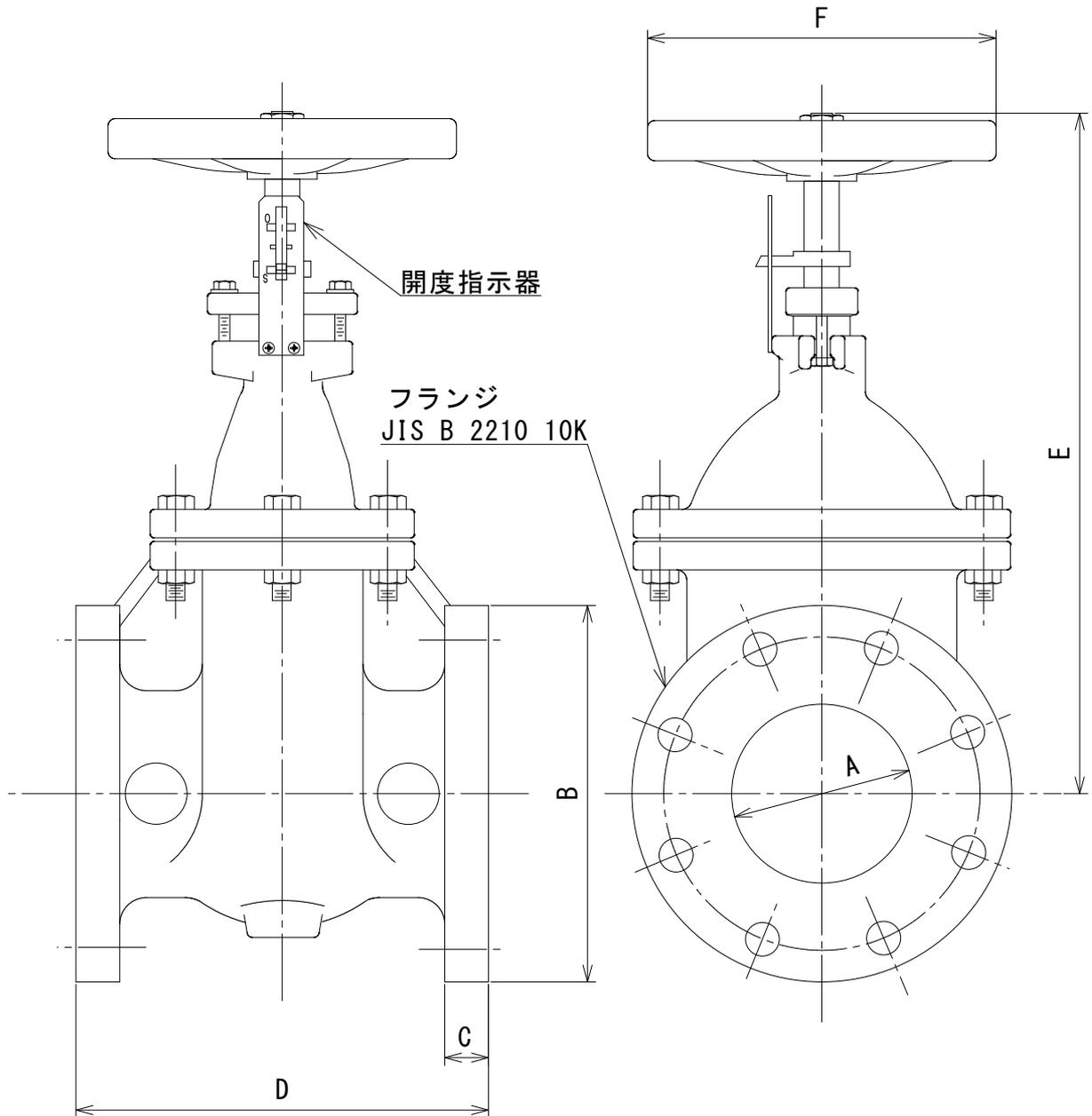
フランジ型内ネジ仕切弁（開度指示器付）
